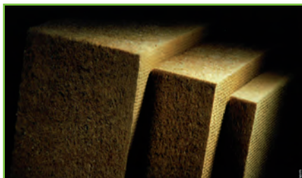
Panneaux de fibre de bois rigide (© Homatherm) Ce matériau présente une masse volumique importante ( \rho = 140 \text{ kg/m}^3 ) et dispose donc de propriétés d'inertie intéressantes
