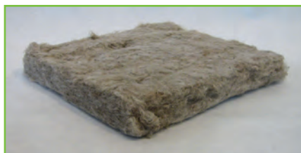
La laine de chanvre est un matériau qui possède une bonne perméabilité avec un coefficient \mu compris entre 1 et 2. A titre de comparaison, le \mu du polystyrène se situe entre 25 et 150.
