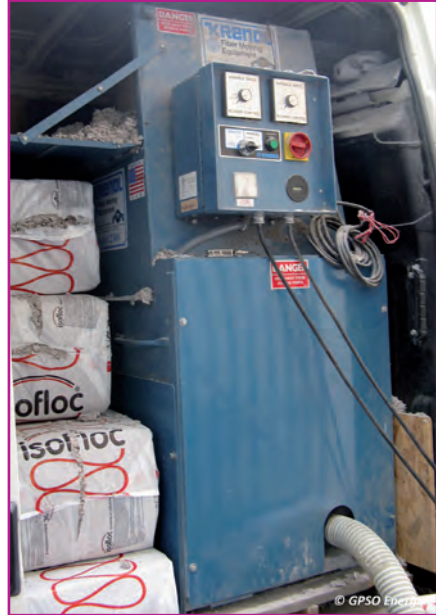
Machine qui broie la ouate de cellulose et qui souffle la ouate dans un tuyau
