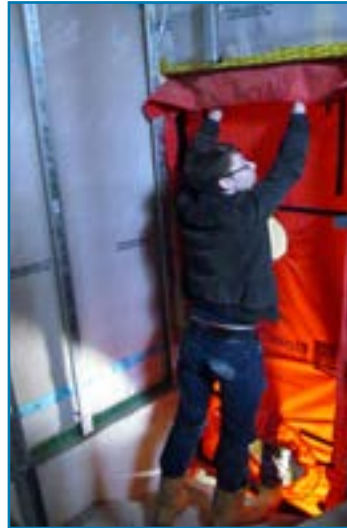
Test de perméabilité à l'air à la porte soufflante Source : GPSO Energie
