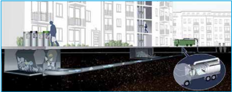
Principe du système de collecte pneumatique du Fort (© Issy.com)
