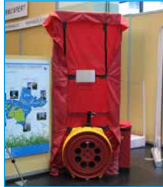
Porte soufflante utilisée pour mettre le bâtiment en dépression ou surpression lors du test de perméabilité à l'air.
